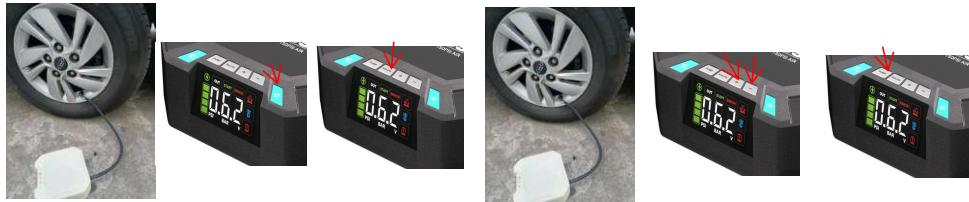
4.1 Le tuyau de gonflage est connecté à l'orifice de sortie du gonfleur, puis l'écrou est serré, et l'autre extrémité est connectée au pneu de la voiture ;
