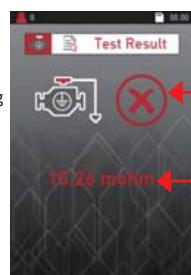
Résultat du test indiquant que la connexion à la terre n'est pas bonne.
