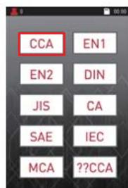
Sélectionnez la mesure de test en fonction de votre batterie
