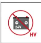
Questo schermo indica se la batteria è a 24 V. Il test non proseguirà se non si tratta di una batteria al piombo da 12 V o di una batteria Li-Ion fino a 18 V.
