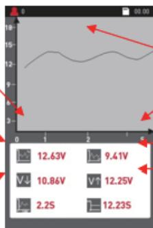
2. Maximale Spannungsabfall während des Kurbelns
