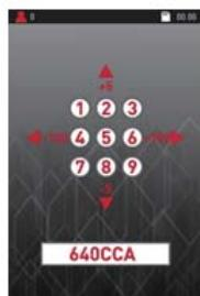
Utilizzare le frecce per inserire il valore da +/- 5 a +/- 100
