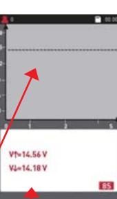
AC Ripple Spannung
