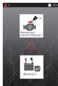
Esta pantalla indica que la pinza negativa debe ser conectada de nuevo al terminal negativo de la batería
